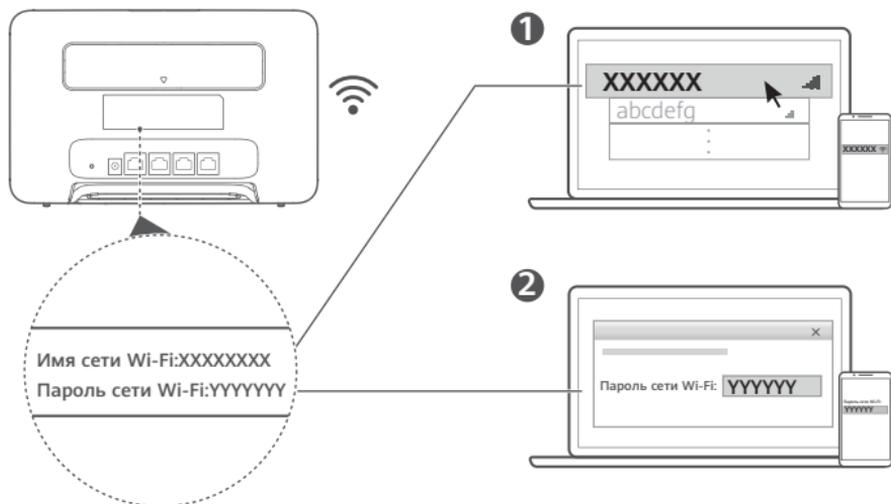
После подключения роутера к мобильной сети передачи данных Вы сможете подключить Ваш ПК или мобильный телефон к сети Wi-Fi роутера для доступа в Интернет. Имя (**Имя сети Wi-Fi**) и пароль (**Пароль сети Wi-Fi**) сети Wi-Fi по умолчанию напечатаны на наклейке, расположенной на задней панели роутера.
